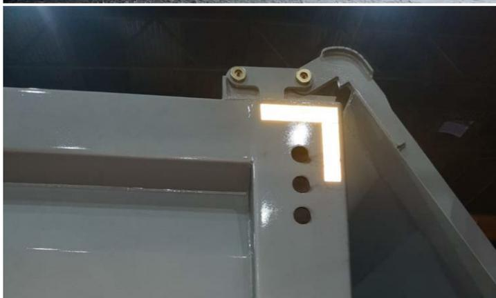
Задний навесной борт на двух-шарнирном исполнении – безопасность выполнения работ при разгрузке груза на приемочные лотки дорожной техники (асфальтоукладчик). Автомобили с обычными задними навесами бортов пересыпают асфальт в лоток асфальтоукладчика, в связи с чем выделяются дополнительные рабочие выполняющие 2 функции:
