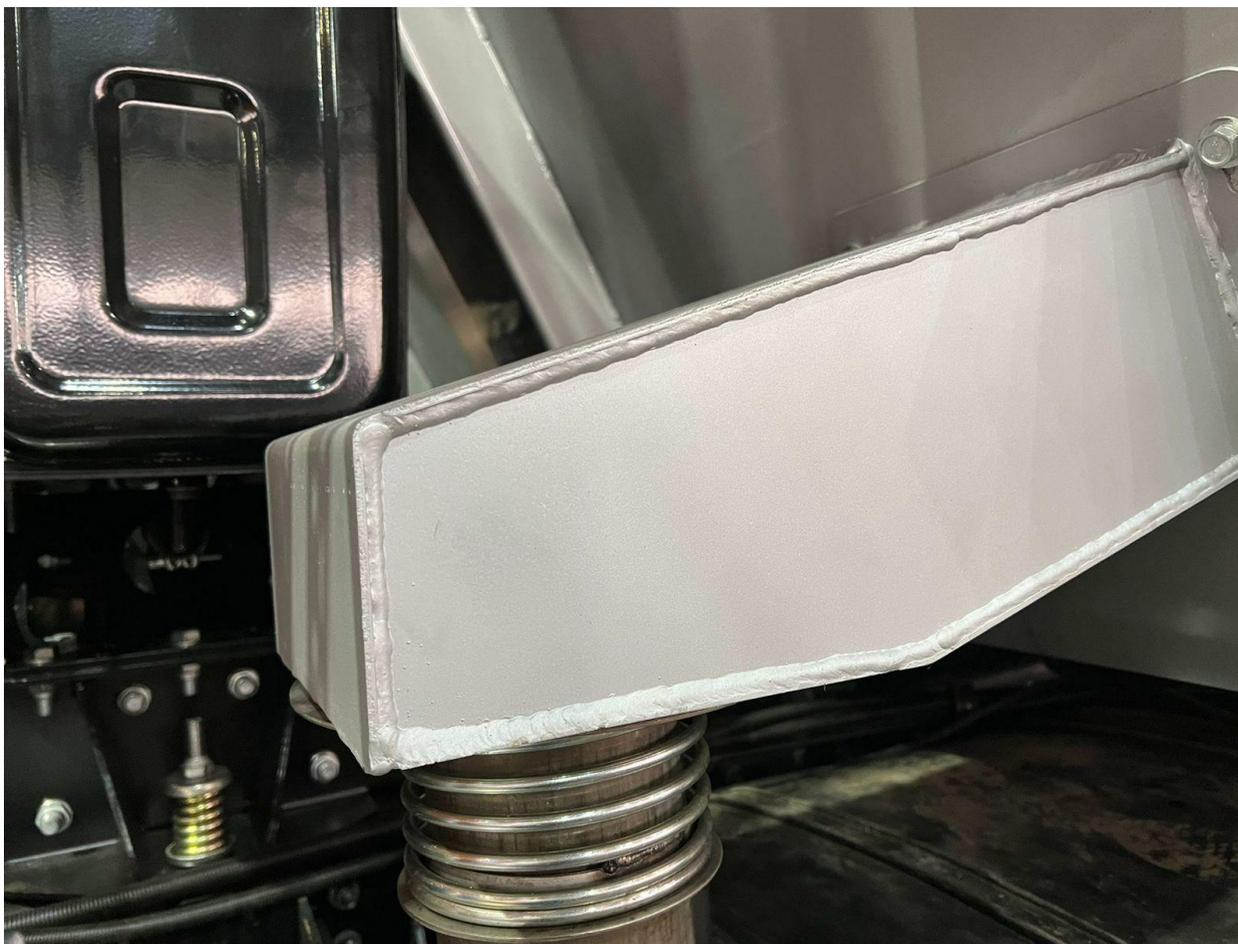
Наши конструктора разработали собственную интегрированную систему обогрева платформы выхлопным газом. Выхлоп распределяется по всему основанию платформы равномерно без турбулентности, с делителем на поток, значительно снижая намерзание грунта в сравнении с платформами данного класса грузоподъёмности от других производителей.
