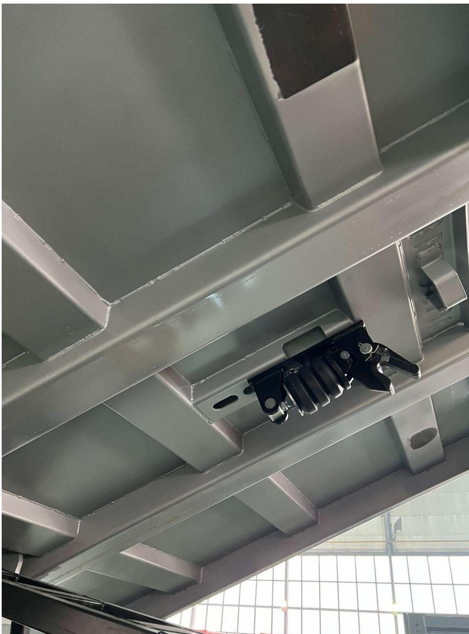
В связи с использованием автомобиля на дорогах с плохим или частично отсутствующим дорожным покрытием, на платформе установлена система блокировки кузова Bodyfix (HYFIX), исключая опрокидыванием кузова и повреждение шасси вызванных выбоинами и неровностями дороги.
