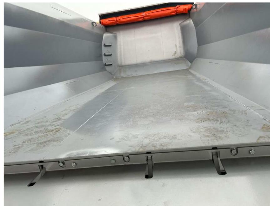
Объём самосвальной платформы 16 куб.м, Грузоподъёмность автомобиля 6522KZ 19 325 кг.
