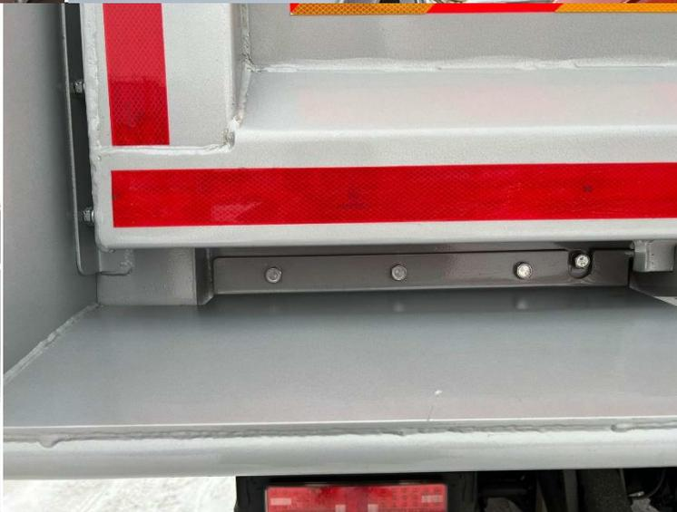
Козырёк над гидрооборудованием и задний лоток самосвальный платформы закреплены на платформе болтовыми соединениями. При необходимости элементы можно заменить без использования резки и сварки. На козырьке болты защищены от срыва и деформации в период эксплуатации специальными гальванизированными шайбами, полностью защищающими крепление болтов от внешних воздействий.
