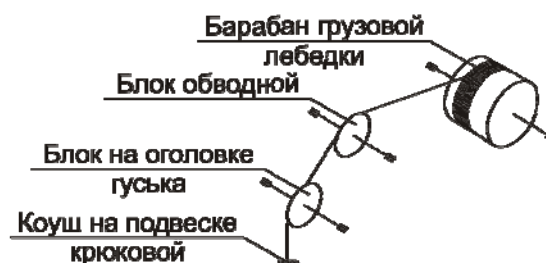
Схема запасовки грузового каната при работе с гуськом
