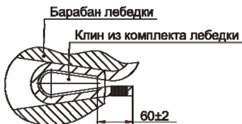
Крепление каната на барабане лебедки
