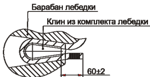
Крепление каната на барабане лебедки
