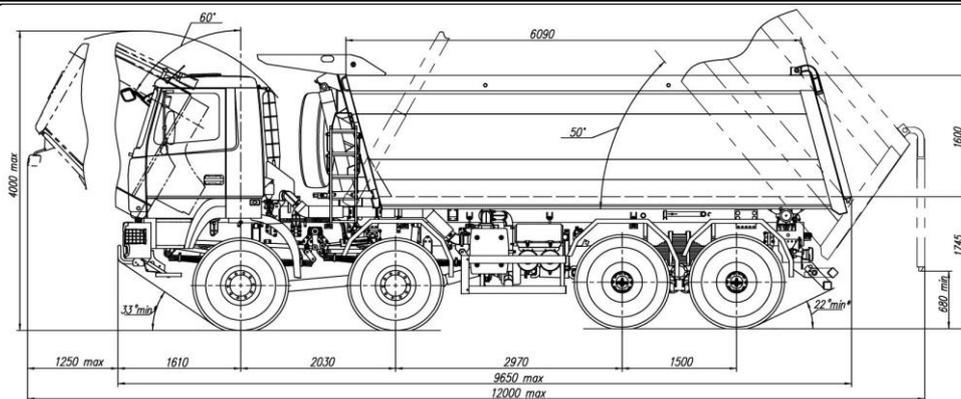
Предназначен для перевозки инертных грузов (песок, гравий и т.д.)
